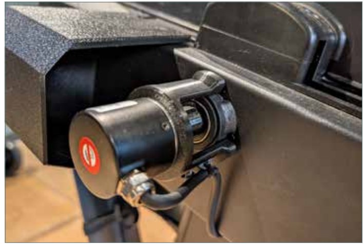
Viele Halterungen wie hier für den Drehgeber an der Rudermaschine entstanden per 3D-Drucker
