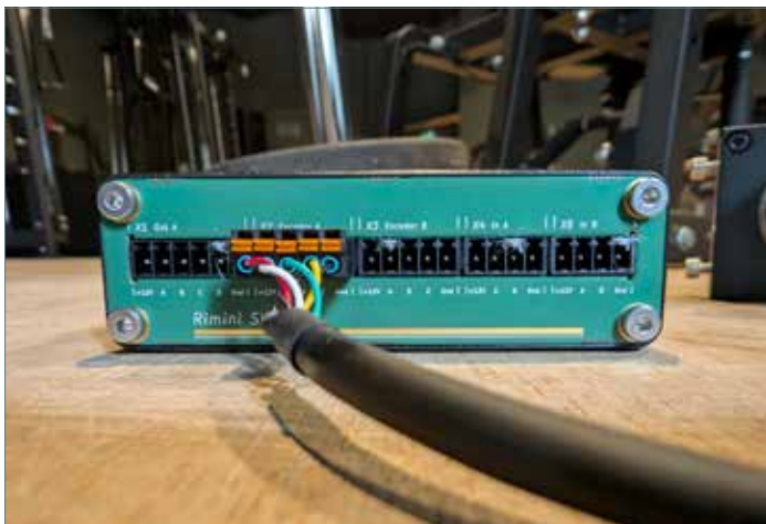
Von Benjamin Maus entwickelt: der „SWEAT Controller“, an den sich bis zu fünf verschiedene Sensoren stecken lassen. Fotos: Benjamin Maus (4)
