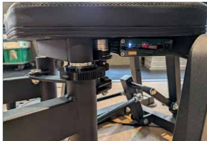
Jedes Fitnessgerät – hier die Beinpresse – hat einen „SWEAT Controller“, der einheitlich konstruiert wurde, um bei Bedarf leicht austauschbar zu sein
